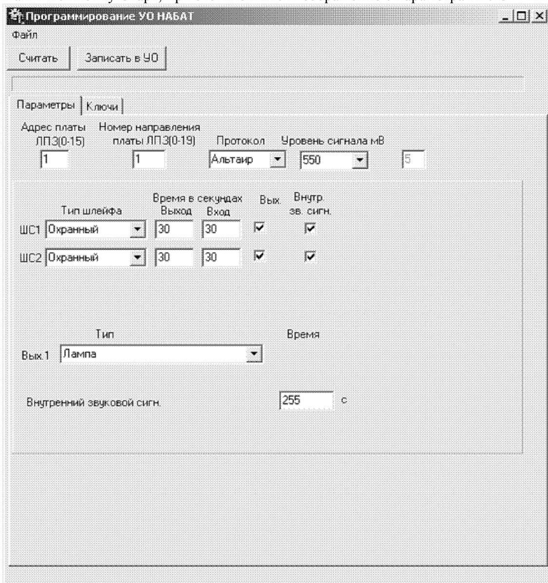
При установке протокола «Альтаир» необходимо указать адрес платы ЛПЗ в корзине ретранслятора, а также номер направления в плате ЛПЗ, к которому будет подключено УО. Если установлен протокол «Фобос-3», то указывать адрес платы и номер направление не нужно.
