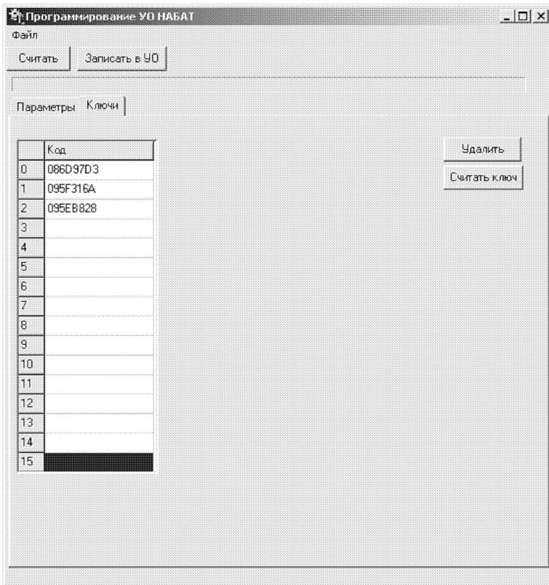
К потребителю прибор приходит с тремя прописанными ключами 0-мастер ключ предназначен только для входа в режим программирования, два остальных ключа соответственно предназначены хозоргану №1 и №2 для взятия и снятия объекта с охраны
